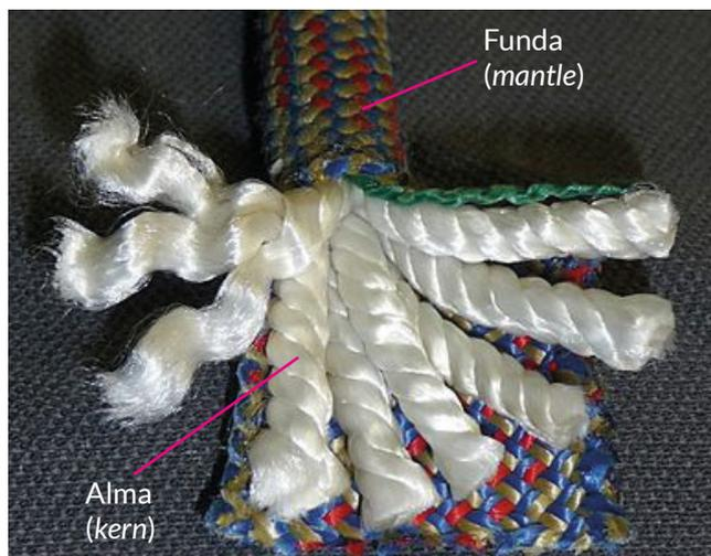
Sección de una cuerda *kernmantle* CU1310105 con alma de cuerdas de poliamida con giro en S y giro en Z (*kern*) y funda de cuerda entrelazada de poliéster (*mantle*).
